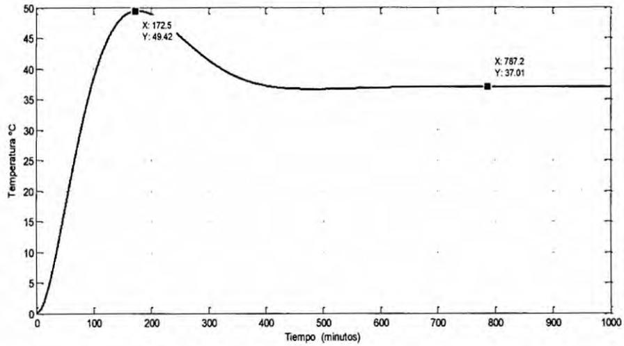
De acuerdo al diagrama de bloques mostrado en la figura N°4.5 se procedió a la simulación cuyo resultado se aprecia en la figura N° 5.2 el regulador PI satisface las consideraciones de sobreimpulso y el factor de amortiguamiento requeridos.
