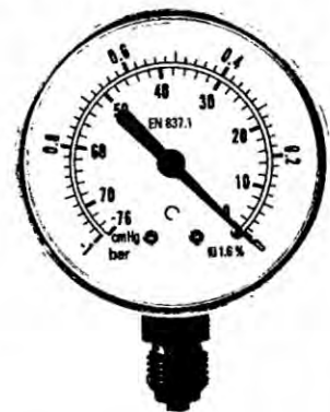
Manómetro clase 1.6 con relleno de glicerina y rosca vertical de 1/4" BSP, mecanismo de bronce, cuerpo acero inoxidable esfera de 2.5" ( 63 mm )
