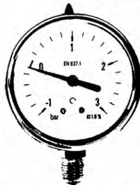
Manómetro clase 1.6 con relleno de glicerina y rosca vertical de 1/4" BSP, mecanismo de bronce, cuerpo acero inoxidable esfera de 2.5" ( 63 mm )
