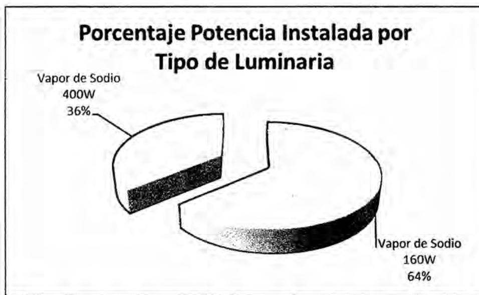
Se puede apreciar que las lámparas de vapor de sodio de 160W, tienen la mayor participación en potencia instalada en el alumbrado exterior con una participación del 64%, seguido con una participación de 36% de las lámparas de Vapor de Sodio de 400W.
