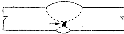
Figura 15 - Penetración Transversal Inadecuada (ICP)
