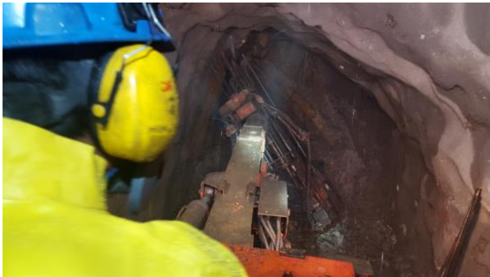
Foto N°3.2: Jumbo en plena perforación en labor con abundancia de agua
