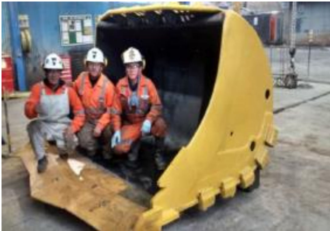
Foto N°3.11: Reparación completa de cucharón de scooptrams R1600G.
