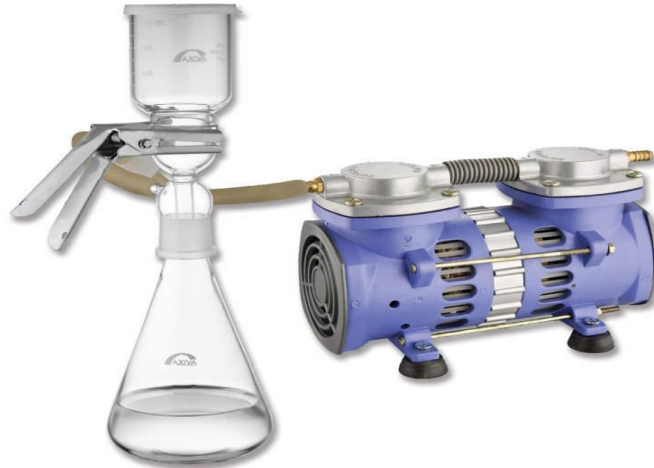
Figura 4. Sistema de filtración al vacío. (De izquierda a derecha: embudo Buchner, pinza sujetadora, matraz Kitasato y bomba).
