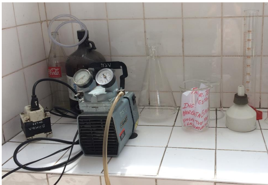
Figura 14. Equipo de filtración.
