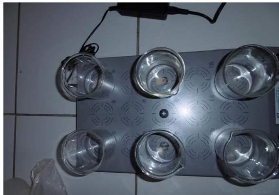
FIGURA N° 4. 5 MEZCLADO DEL ALMIDÓN NATURAL A DIFERENTES CONCENTRACIONES EN EL AGUA SUPERFICIAL
