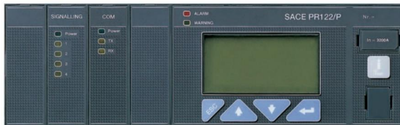
Figura N° 53. Vista frontal del relé PR122.
