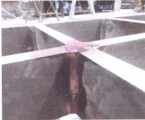
**FIGURA Nº1:** En la figura se observa, que se realizo la inspeccion por liquidos penetrantes. Se rocío con spray el PENETRANTE al cordon de soldadura, se espera un promedio de 5 minutos para su inspeccion.
