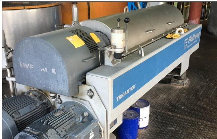
Fotografía 2. Máquina eléctrica extractora de aceite de semillas de palma (TRICANTER FLOTTWENG Z4E-4/441). Fotografía tomada el 30.03.2018.
