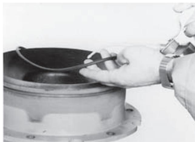
La tapa de aspiración (132) se colocará en posición hacia afuera de modo que las tuercas exteriores (27) cojan en algunas filetas de rosca.
