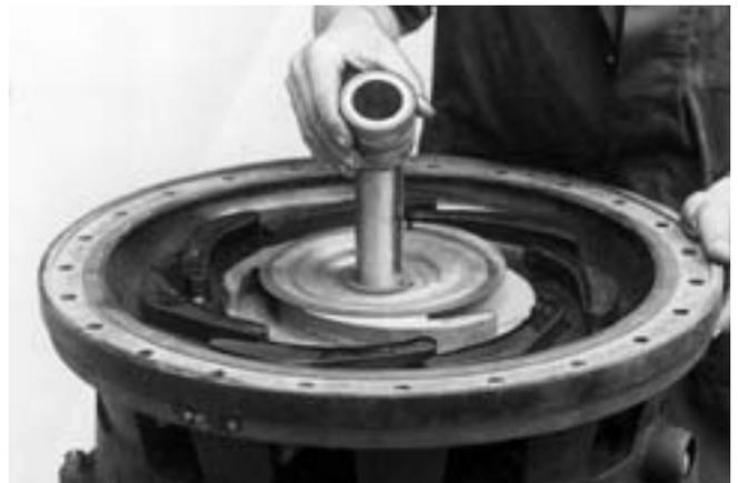
Colocar la herramienta de ajuste 400 21 00 en el anillo difusor, tal como muestra la figura. Enroscar de modo que el tornillo de la herramienta apenas toque el disco de paletas directrices (141).
