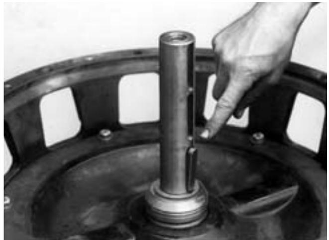
Colocar luego el anillo difusor (138), sujetarlo temporalmente con algunos tornillos (7) de modo que quede en su posición correcta, lo cual es muy importante para continuar el ajuste del impulsor.
