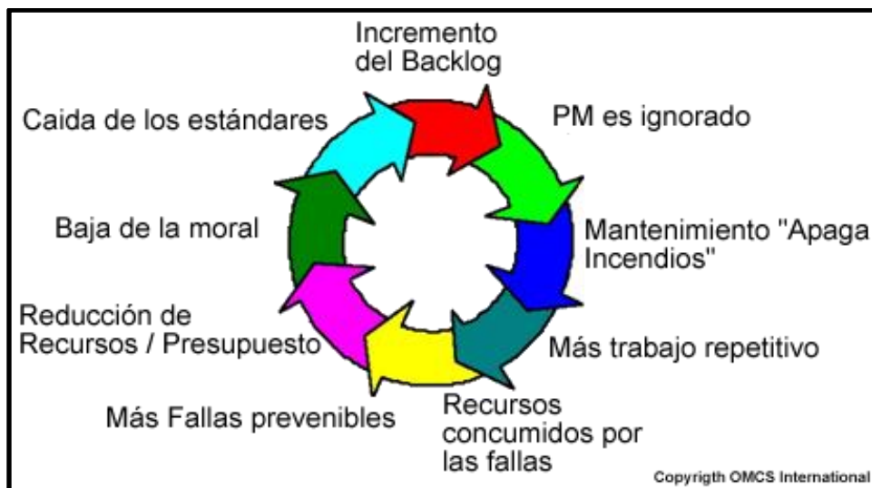
Figura 2-3 Ciclo Vicioso de Mantenimiento Reactivo
