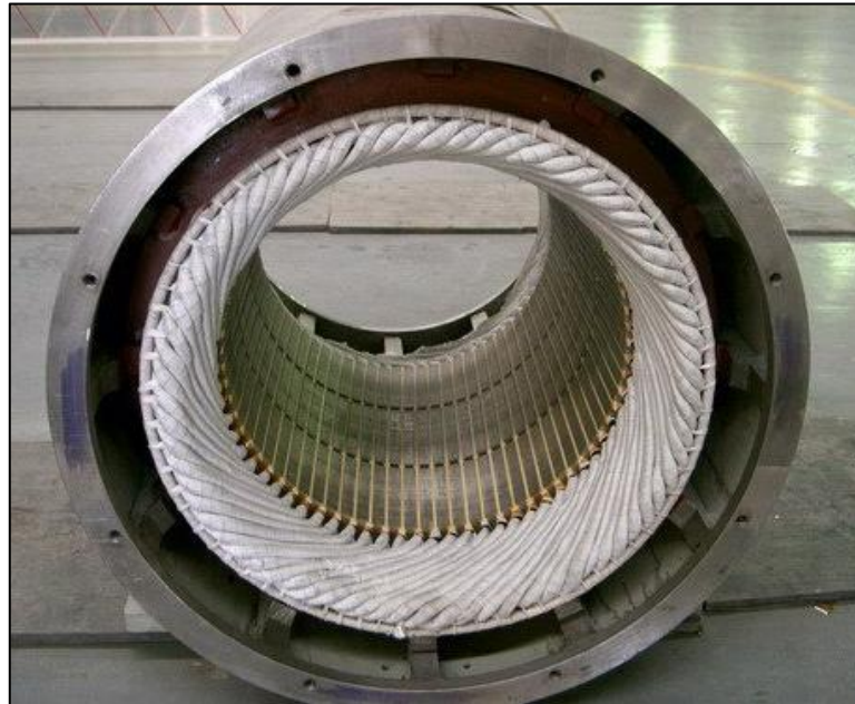
FIGURA 5. DEVANADO DE UN ESTATOR FUENTE: Guangzhou ENGGA Generators
