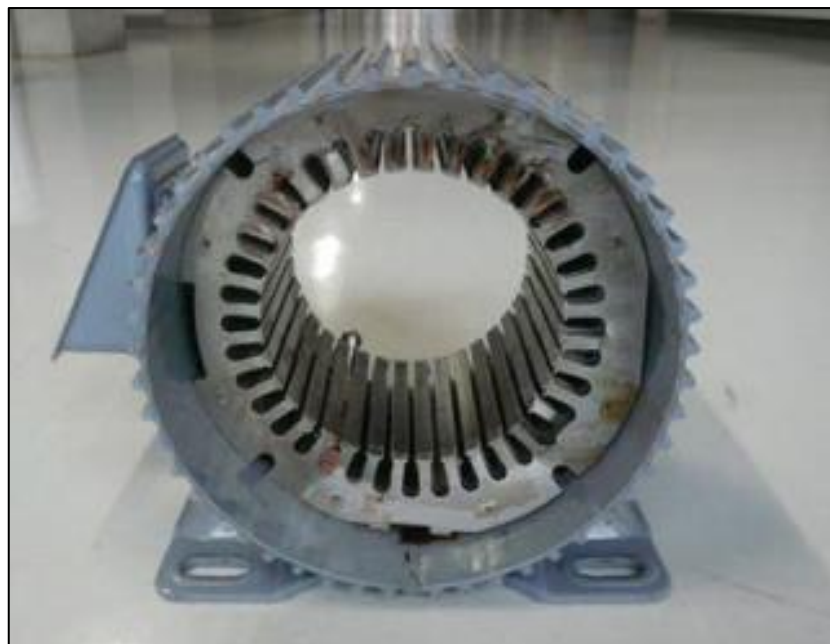
FIGURA 6. SOPORTE DEL ESTATOR FUENTE: (Nakamura, et al. 2012)
