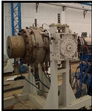
*Figura 2.7.* Sistema moldeador de núcleo de tubo rectangular
