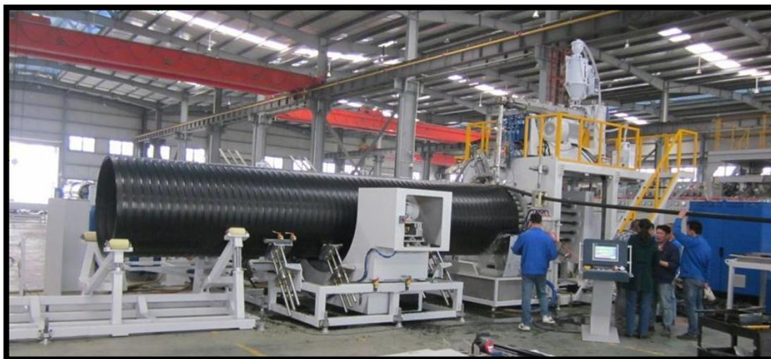
*Figura 2.38.* Vista del enrollado del perfil para formación de tubos HDPE.
