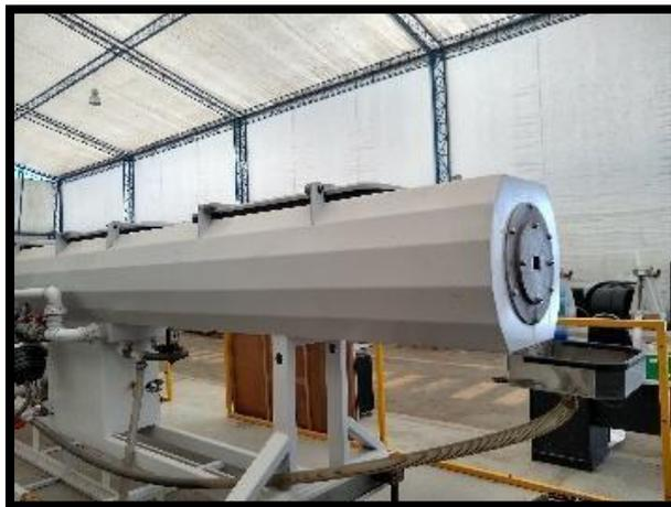
*Figura 2.9:* Sistema de refrigeración por aspersión
