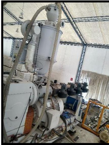
*Figura 2.13.* Sistema de extrusora soldadora LSS-65.
