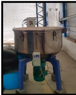
*Figura 2.14.* Batidora con motoreductor.
