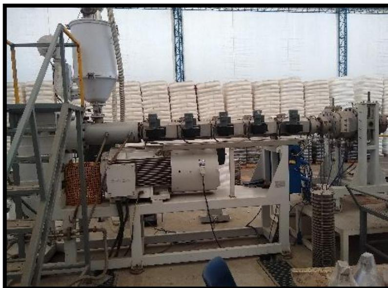
*Figura 2.5.* Sistema de extrusora LSS-80.
