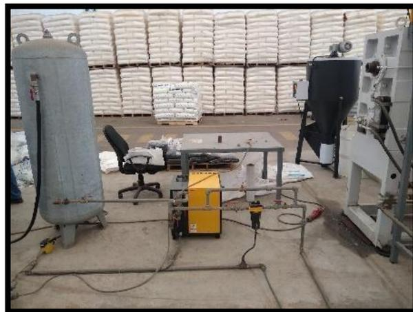
*Figura 2.19.* Tanque pulmón y secador
