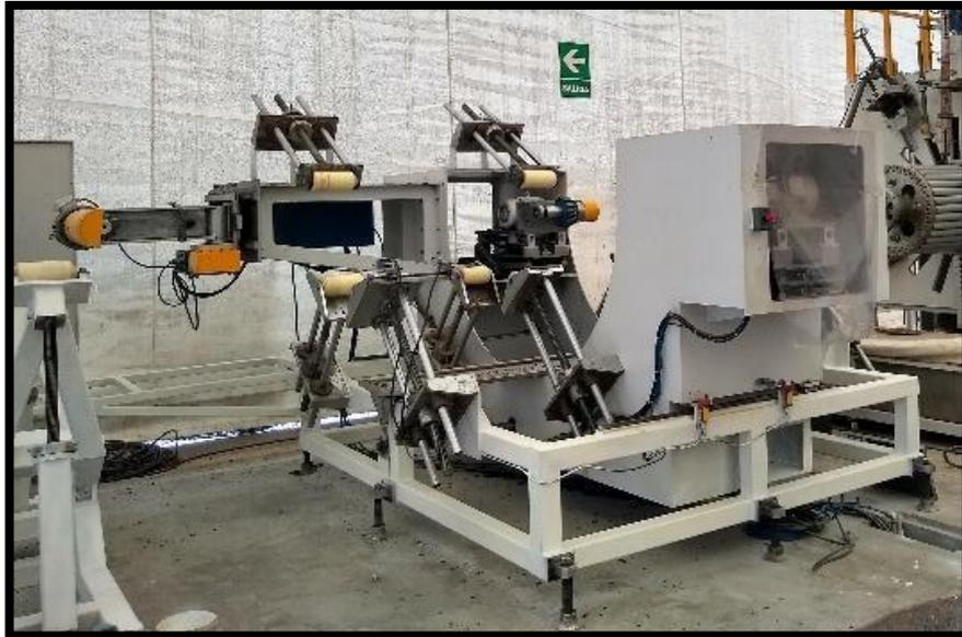
*Figura 2.15.* Sistema de roscado y corte.
