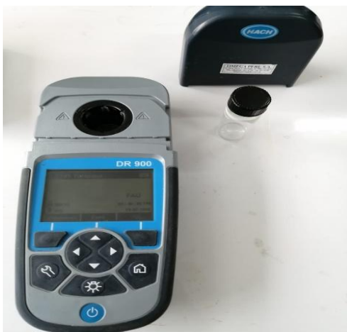
Figura22 Colorímetro marca HACH DR900 (Rango 0-1000NTU)
