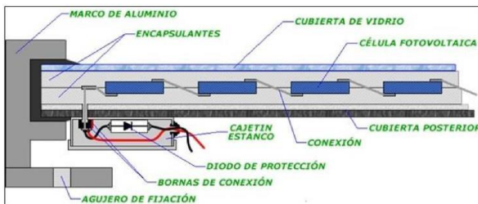
Figura 7. Sección de un panel fotovoltaico
