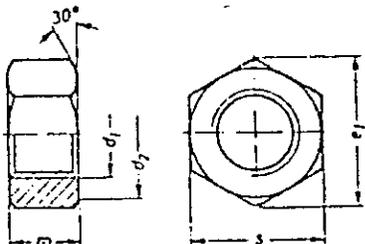
Die Muttern sind auf beiden Seiten unter 120° bis auf den Gewindedurchmesser ausgeleitet.
