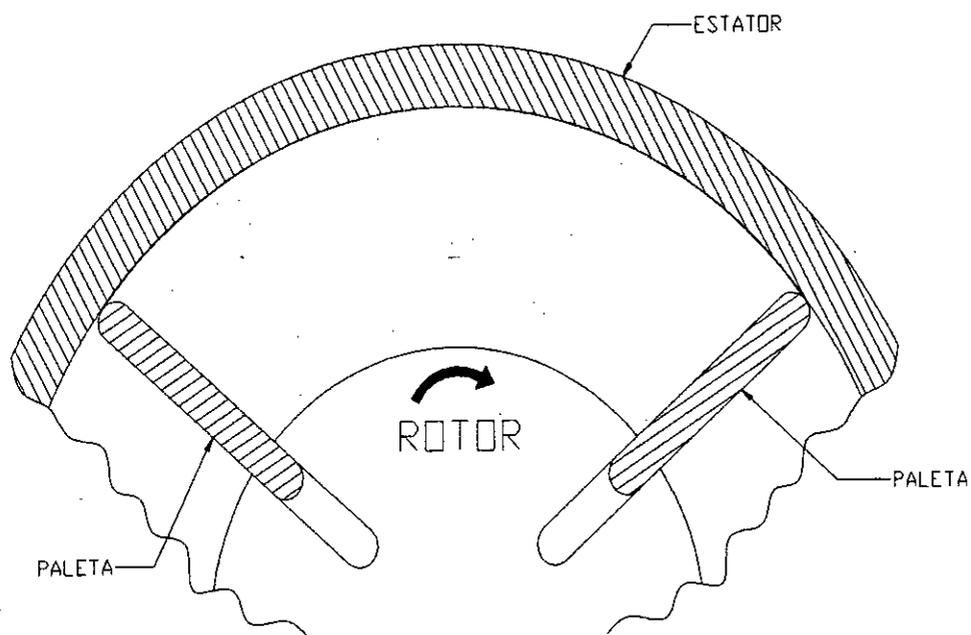
El volumen comprendido entre el ROTOR, el ESTATOR y DOS PALETAS CONSECUTIVAS, lo definimos como el producto del área transversal respectiva, creada por un corte perpendicular al eje de la Bomba, por el ancho del estator ó rotor.
