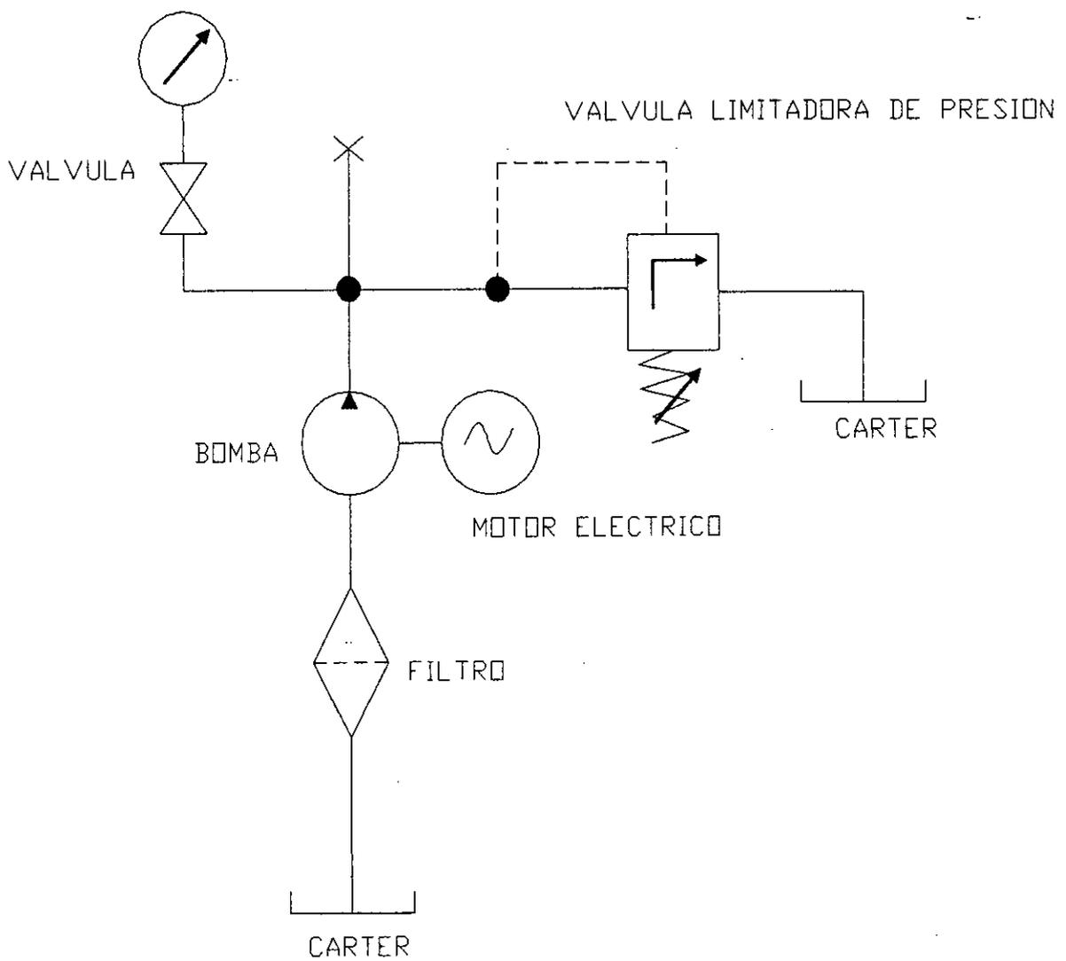
DIAGRAMA DE PRINCIPIO DE LA UNIDAD DE POTENCIA
