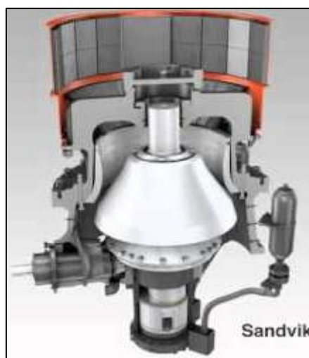
Figura 9. Trituradora cónica Sandvik CH660 Fuente: Sandvik S.A. (S/F)
