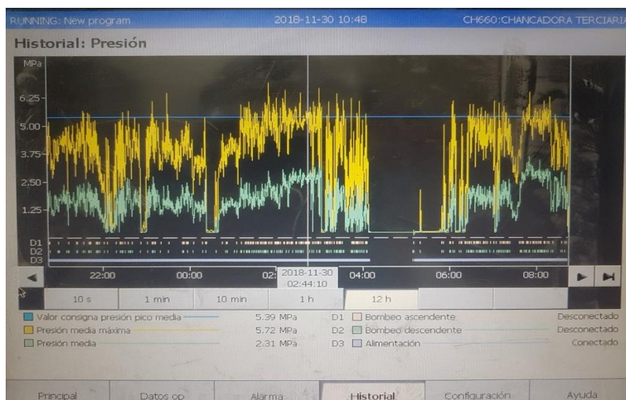
Figura 29. Panel ASRI chancadora terciaria Fuente Elaboración propia
