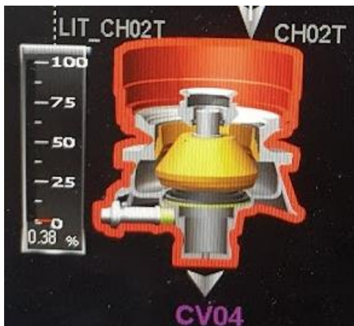
Figura 32. Nivel mínimo de Chancado de Chancadora Terciaria Fuente: Elaboración propia
