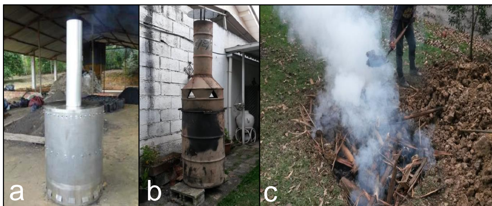
Figura 7. Técnicas de producción de biochar (a. producción en un horno de doble tambor, b. producción en un horno de retorta y doble tambor, c. producción bajo tierra) Fuente: Extraído de (Guerra 2015; Iglesias Abad 2018)
