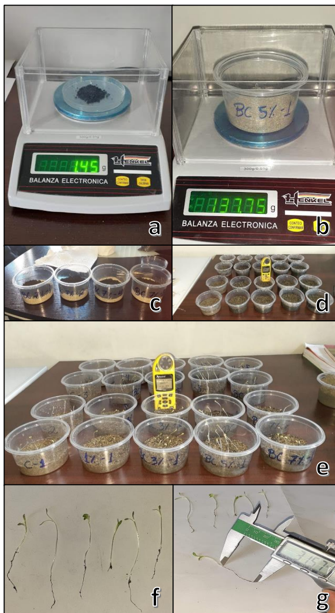
Figura 33. Bioensayos de germinación y desarrollo de la plántula Lactuca sativa L. (a. Peso de la dosificación de biochar, b. Peso de la cantidad correspondiente de arena, c. Combinación de ambas dosificaciones, d. Siembra de semillas e inicio de la prueba, e. Desarrollo de las plántulas, f. Fin de la prueba y extracción de las plántulas desarrolladas, g. Medición correspondiente a cada plántula.)
