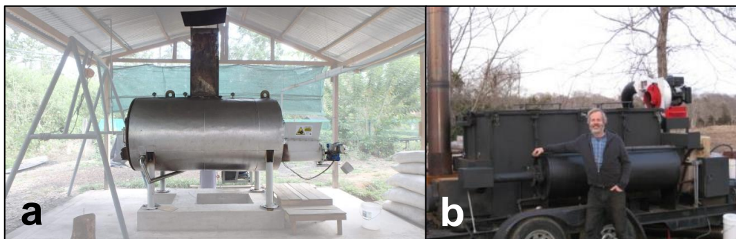
Figura 9. Hornos de producción de biochar ( a. pirolizador de flujo continuo, b. horno de retorta móvil).
