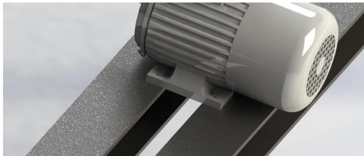
Figura 4. 50 Motor del ascensor
