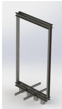
Figura 4. 20 Estructura del bastidor de la cabina
