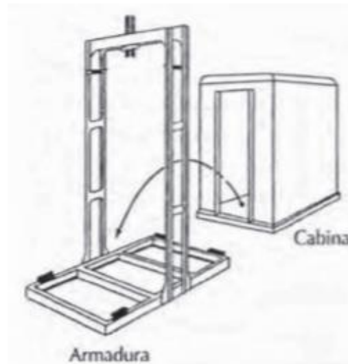
Figura 2. 7 Esquema de cabina y bastidor o armadura
