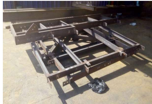
IMAGEN 2: Pasarela de Faja n° 1
