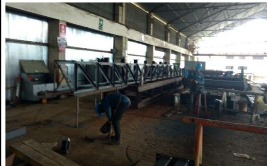
IMAGEN 5: Armado de celosías
