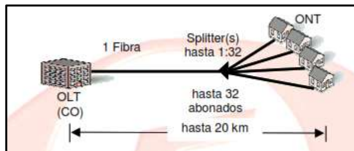
Figura N°15. RED DE TRANSMISIÓN BASADA EN ARQUITECTURA PON
