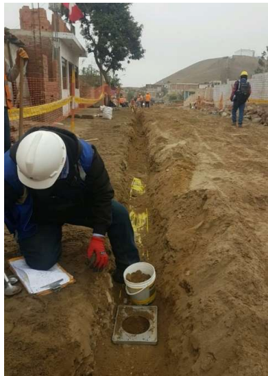
FIGURA N° 44 Pruebas de compactación
