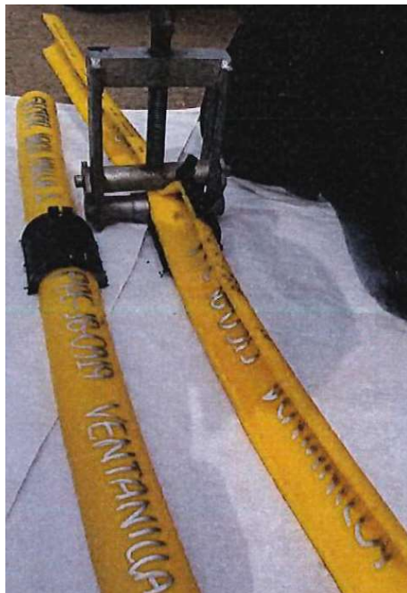
FIGURA N° 42 Ensayo por aplastamiento
