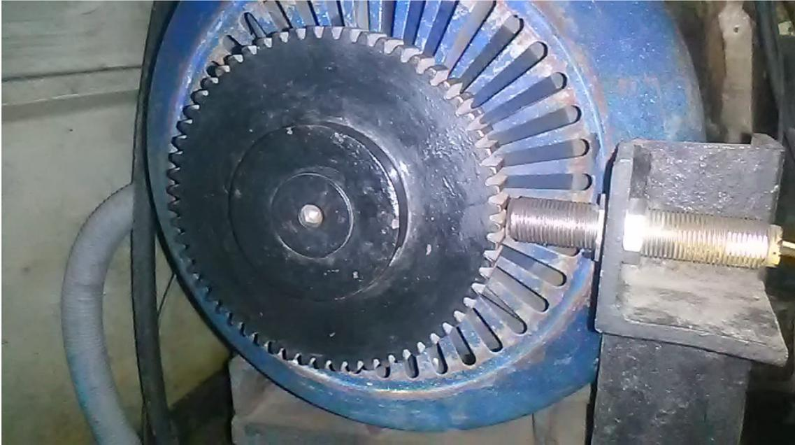
Figura 61: Instalación del Sensor Pickup
