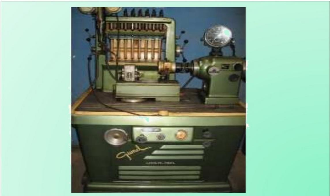
Figura 3: Banco de pruebas para bomba inyectora
