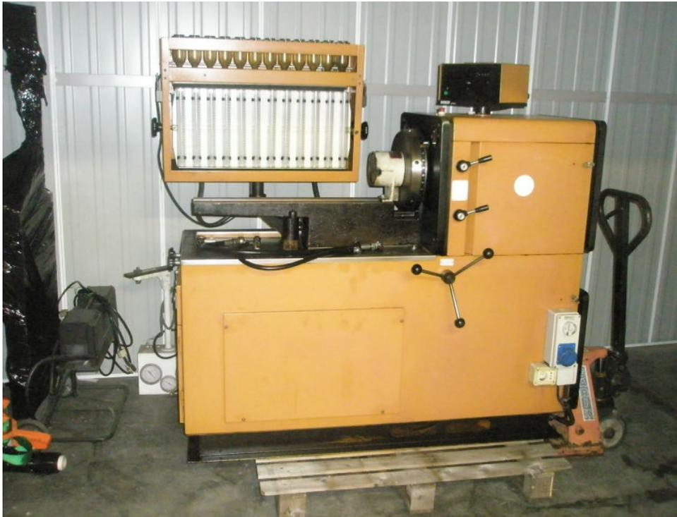
Figura 4: Banco de pruebas inyección diésel Bosch Eps 604
