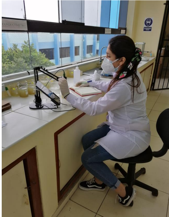
Foto 7. Medición de la conductividad y el pH
