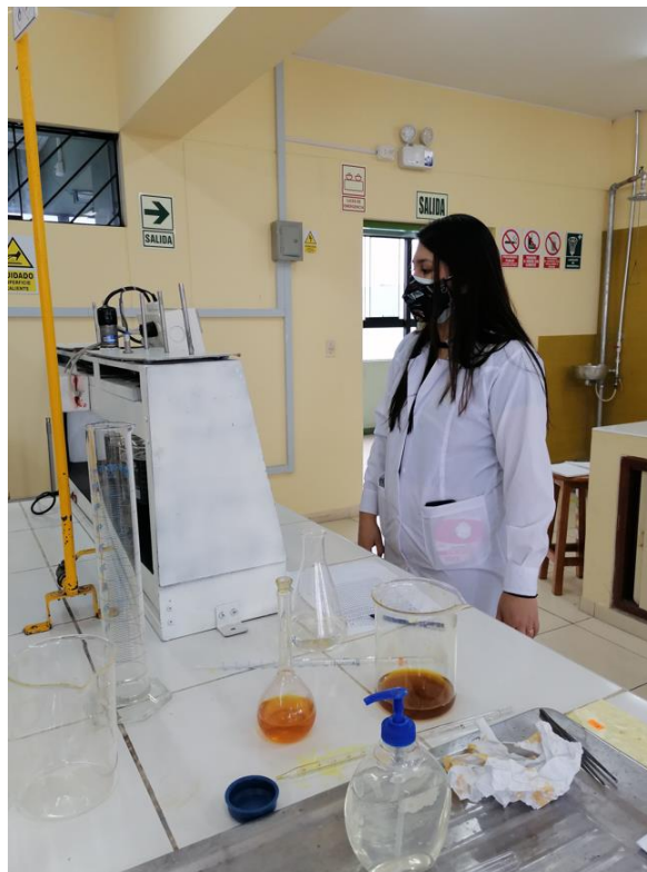
Foto 4. Desarrollo del proceso de coagulación-floculación en la prueba de jarras
