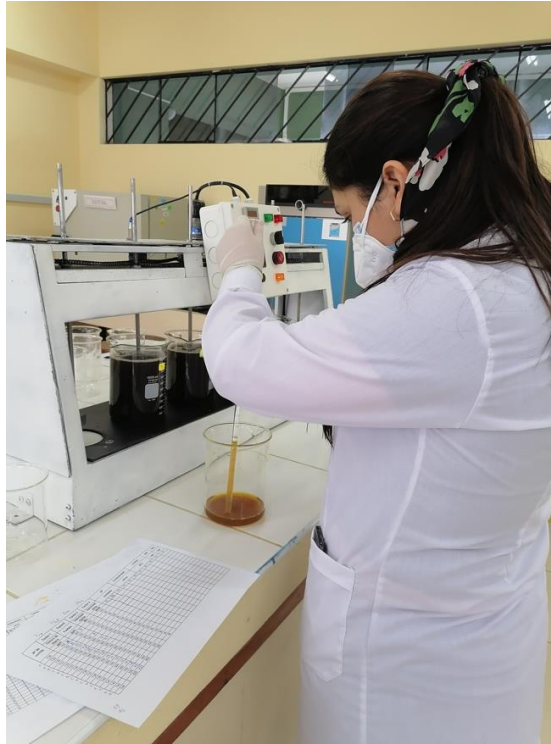
Foto 3. Adición de cloruro férrico al agua residual de matadero en la prueba de jarras
