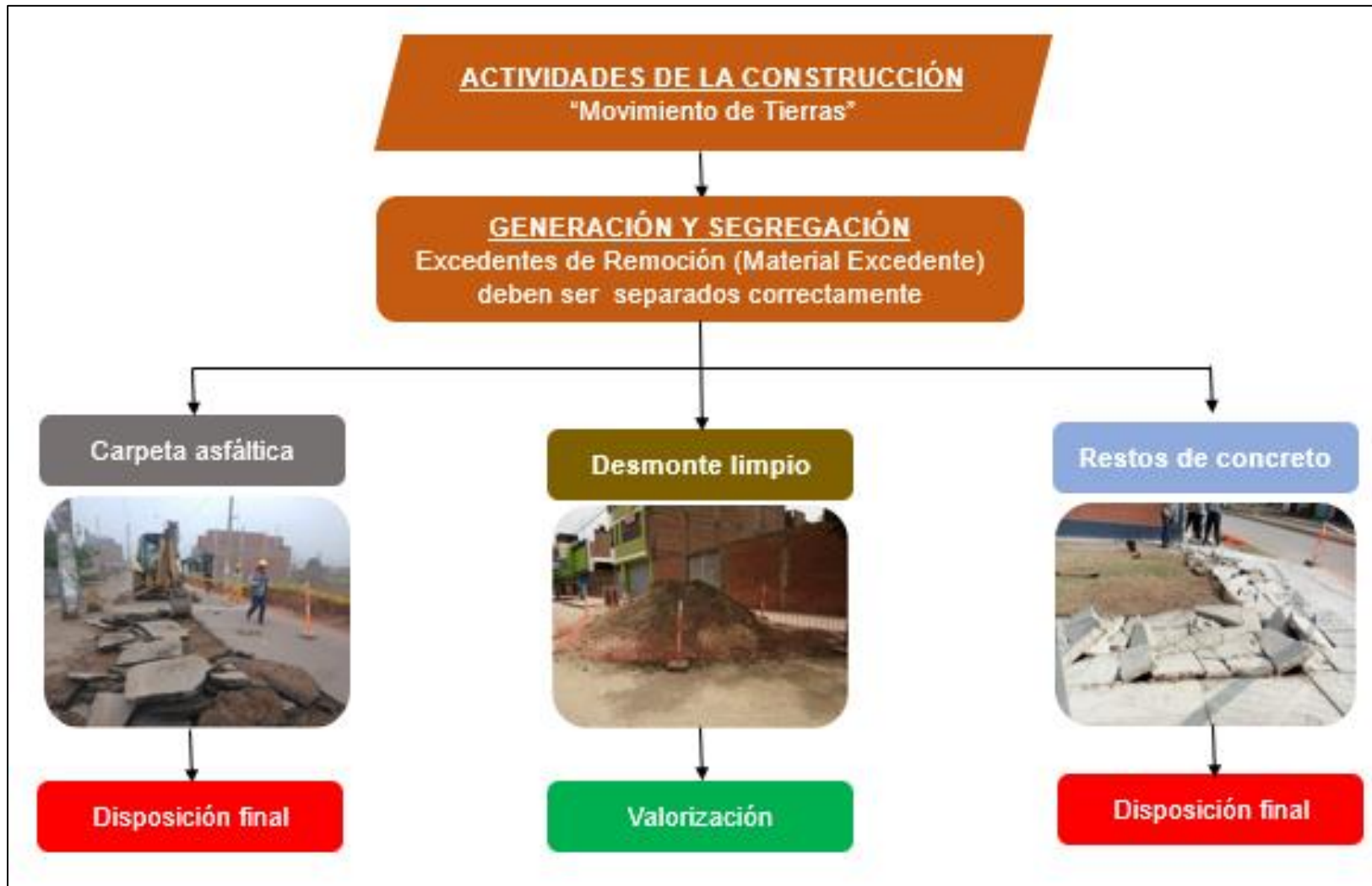
Figura 33. Identificación de desmante limpio de los excedentes de remoción (material excedente)
