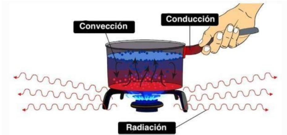
Figura 1. Tipos de transferencia de calor. Tomado de “Concepto.de”, por Raffino. 2021. parr.1.
