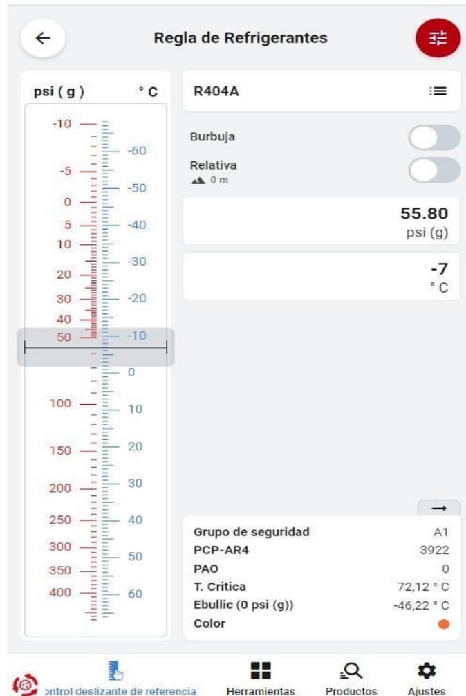
Figura 57. Resultado de la presión de trabajo en la línea de succión. Tomado del "Software regla de refrigerantes" por el fabricante Danfoss.
