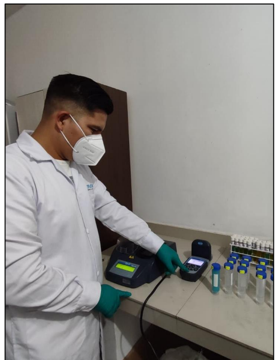
iv. Medición de la DQO por el colorímetro.
