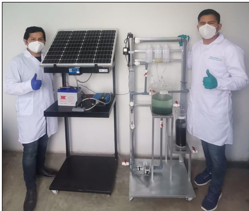
iii. Prototipo autónomo de foto-Fenton y adsorción en funcionamiento.
