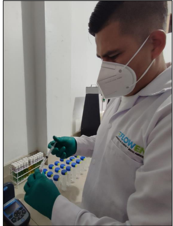
ii. Agregado de 2,5 mL/L de agua residual de cada muestra tratada.
