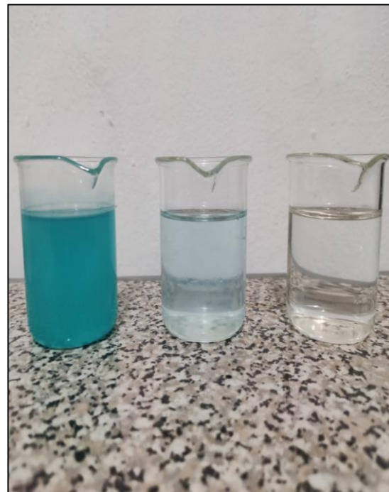
iv. Aspecto del agua residual, agua tratada después de foto-fenton y después de adsorción.
