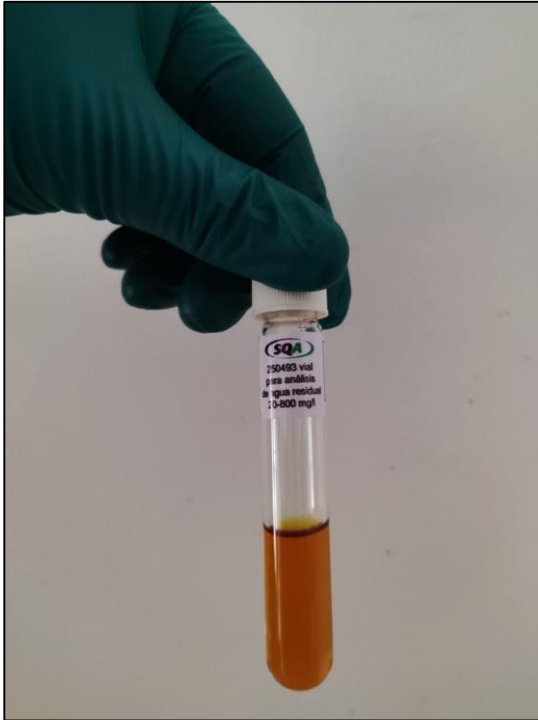
i. Vial con reactivos para determinar DQO.
