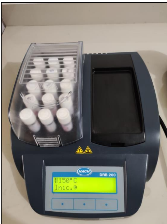
iii. Digestión de los viales a 150 °C por 2 horas.
