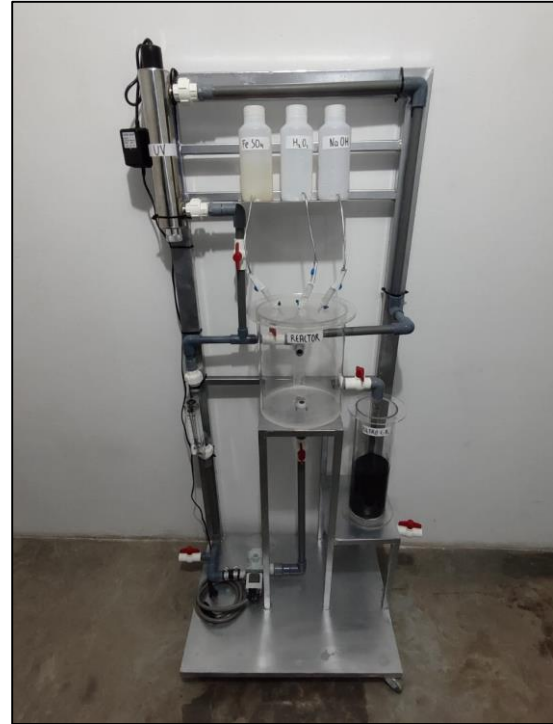
ii. Montaje del sistema foto-Fenton y adsorción.
