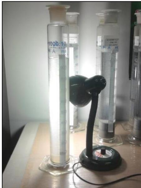
**Figura 20.** Vista de probeta con muestra de agua de mina durante prueba para determinar la velocidad de sedimentación.
