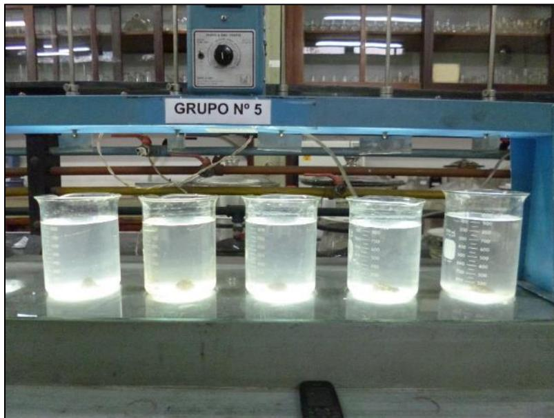
**Figura 18.** Vista de los flóculos sedimentados en la prueba N° 12.
