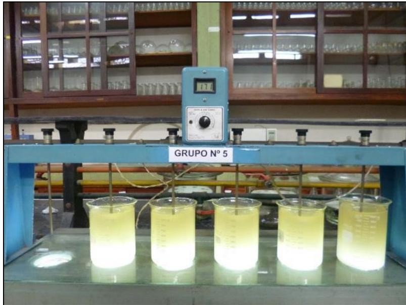
**Figura 17.** Vista de la prueba de jarras N° 12 con sulfato de aluminio y A-110.
