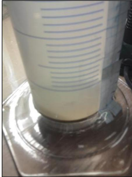
**Figura 21.** Vista de los sólidos sedimentados luego de 24 horas.
