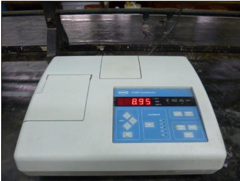
**Figura 19.** Vista del valor de la turbidez en prueba N° 12.
