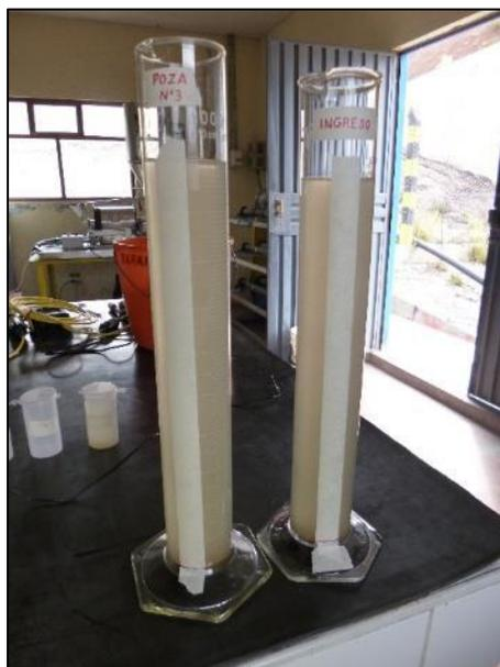
**Figura 8.** Muestras de agua de mina de la poza de decantación N° 3 e ingreso a sistema de tratamiento físico químico.
