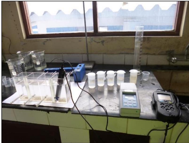
**Figura 16.** Medición de parámetros fisicoquímicos en prueba de jarras N° 11.
