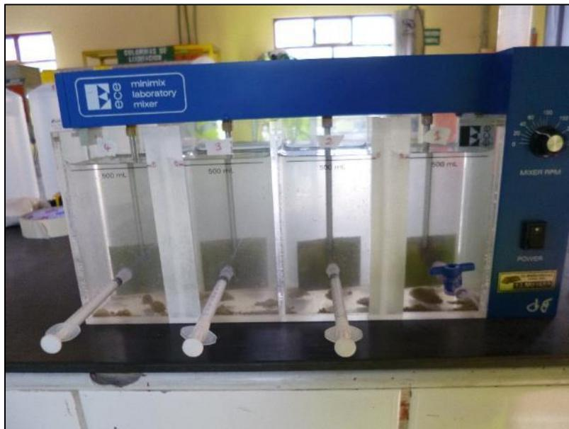
**Figura 10.** Vista de los flóculos sedimentados durante la mezcla lenta.
