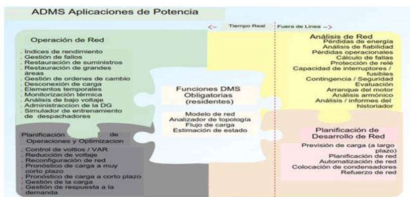
Figura 25 - Aplicaciones de ADMS en Energía Eléctrica.
