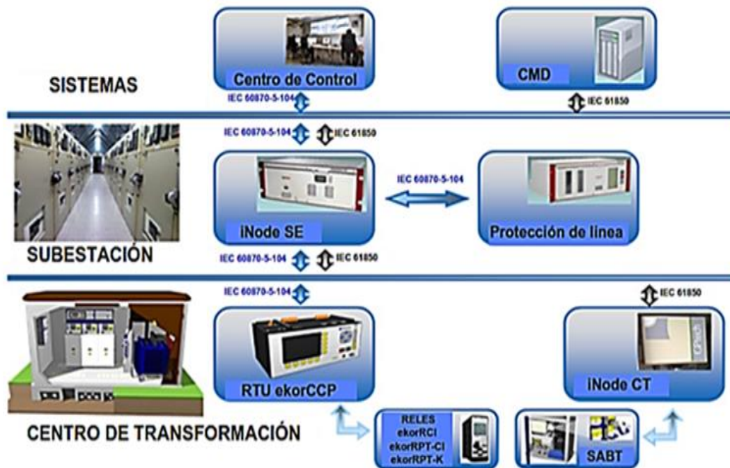
Figura 81 - Propuesta de la Automatización de la red de MT.
