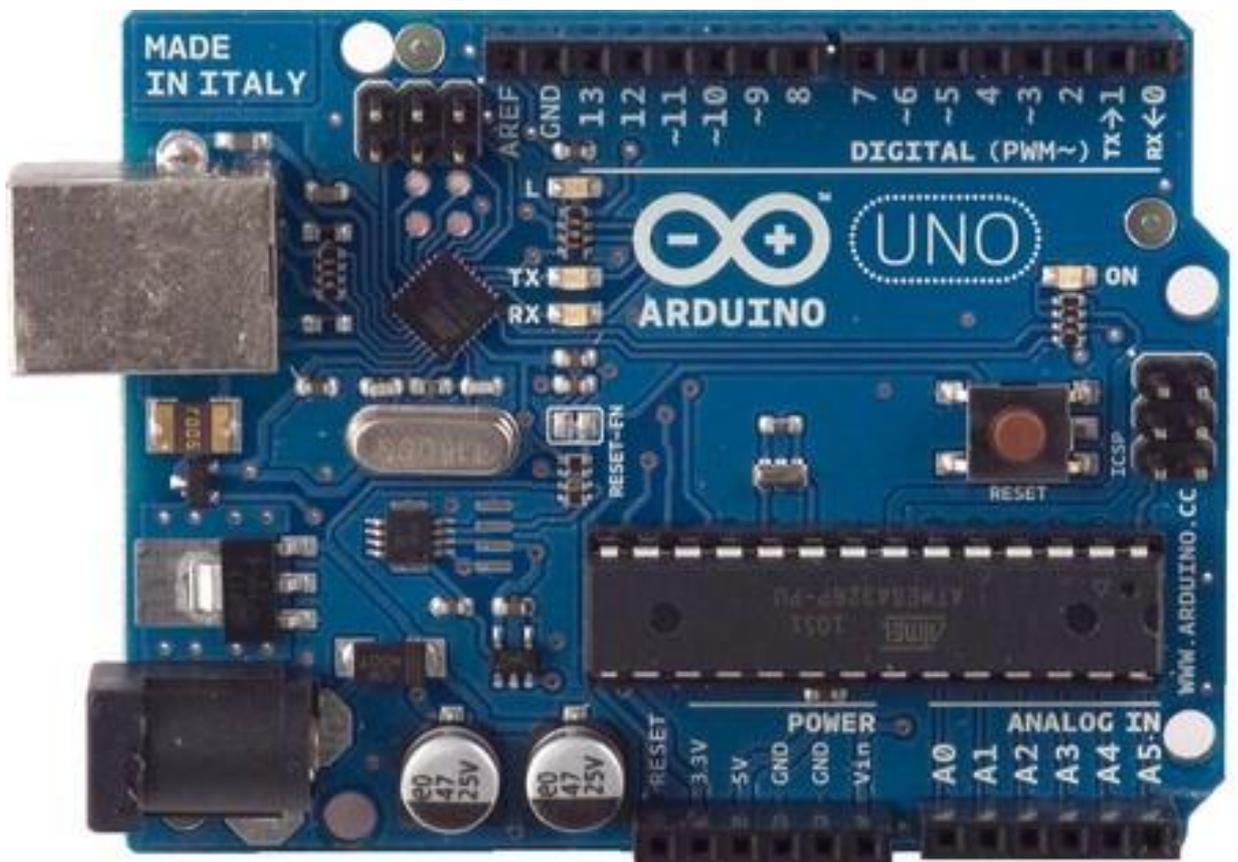
Figura 23. Placa de Arduino
