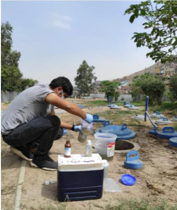
Fotografía 1.- Toma de muestra de agua residual para análisis de laboratorio
