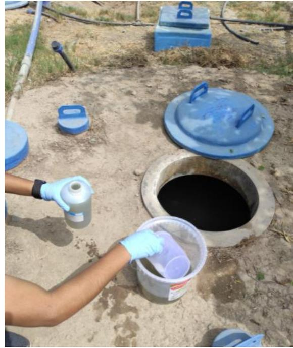
Fotografía 2.-Toma de muestra del Tanque Ecuilizador (tratamiento primario)
