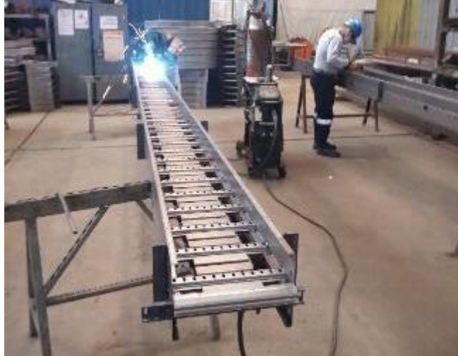
Imagen 69 Proceso de soldeo de bandejas escaleras
