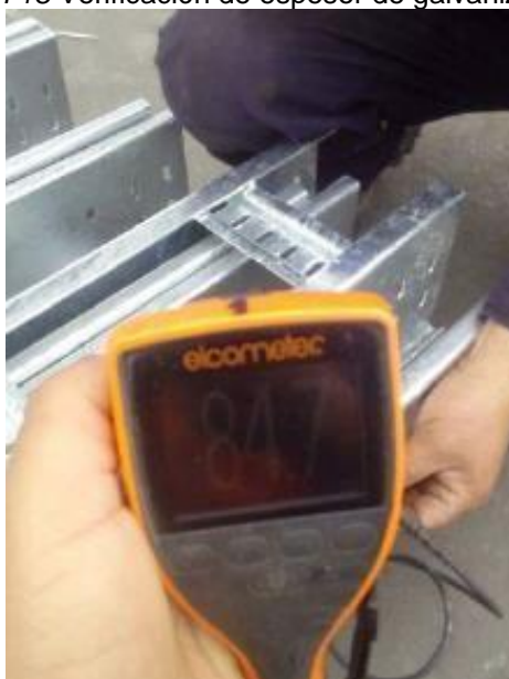
Imagen 18 Verificación de espesor de galvanizado
