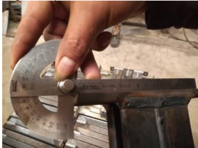
Imagen 68 Inspección dimensional al material soldado
