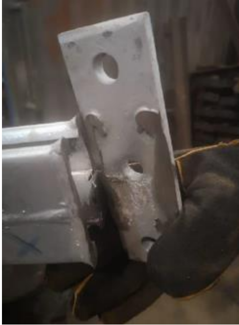
Imagen 34 Vista de zonas con soldadura remanente
