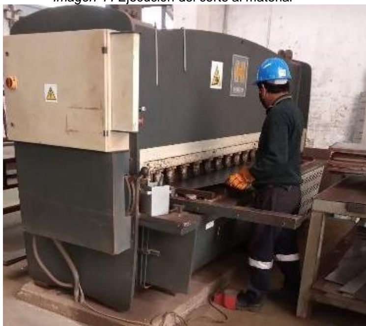
Imagen 44 Ejecución del corte al material
