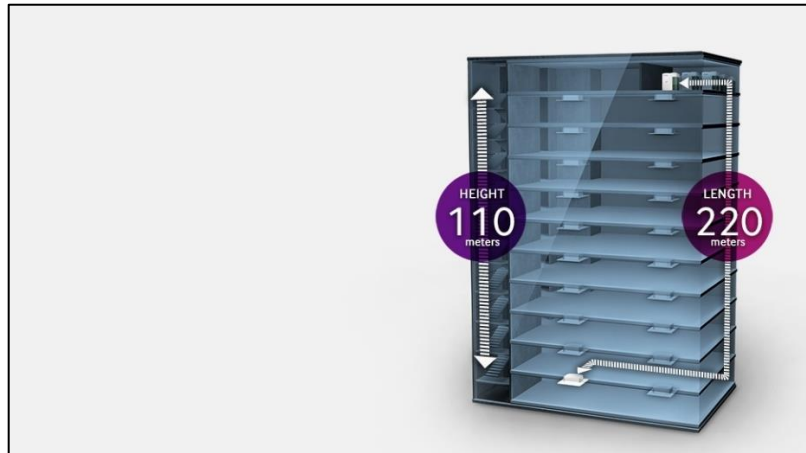
Figura 13. Longitudes de la tubería de refrigeración del sistema de aire acondicionado VRF DVMS instalado en edificaciones, tomado de la página web de la marca SAMSUNG.
