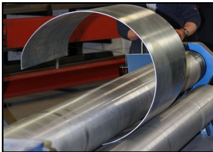
Figura 3.19 Rolado de plancha metálica
