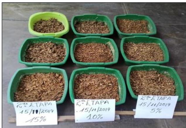
En la Figura N° 6 se muestran las bandejas con la arcilla residual y el bagazo de caña de azúcar, a los 45 días de tratamiento con distintas cantidades de hongo *Penicillium janthinellum*, siendo estas: 75 ml a una concentración de  $337.5 \times 10^3$  conidias/ml, 150 ml a una concentración de  $675 \times 10^3$  conidias/ml, y 225 ml a una concentración de  $1,012.5 \times 10^3$  conidias/ml.
