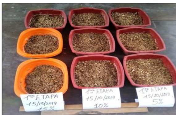
En la Figura N° 5 se muestran las bandejas con la arcilla residual y el bagazo de caña de azúcar, a los 30 días de iniciado el tratamiento con distintas cantidades de hongo *Penicillium janthinellum*, siendo estas: 75 ml a una concentración de  $337.5 \times 10^3$  conidias/ml, 150 ml a una concentración de  $675 \times 10^3$  conidias/ml, y 225 ml a una concentración de  $1\,012.5 \times 10^3$  conidias/ml.
