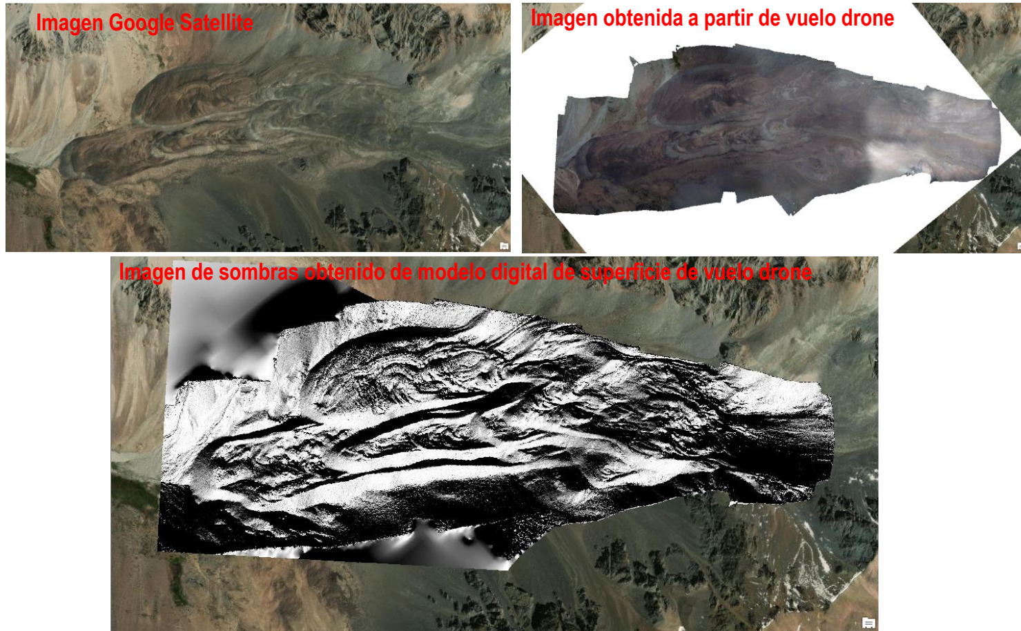
Imagen 4. Ortomosaico y mapa de sombras obtenido de vuelo drone en el glaciar de roca San Félix.
