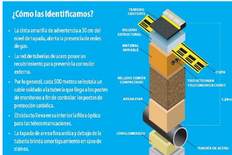
FIGURA 2. 7 INSTALACIÓN DE REDES EXTERNAS DE ACERO
