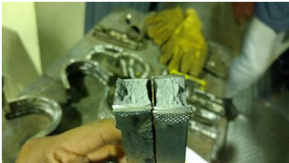
FIGURA 3. 24 ENSAYOS PARA CALIFICACION DE WPS
