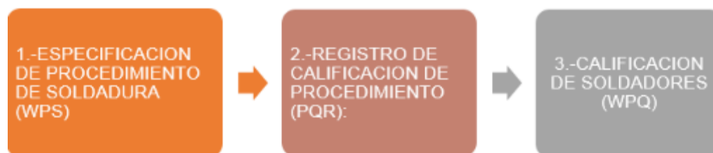
FIGURA 3. 7 SECUENCIA DE CALIFICACION EN SOLDADURA
