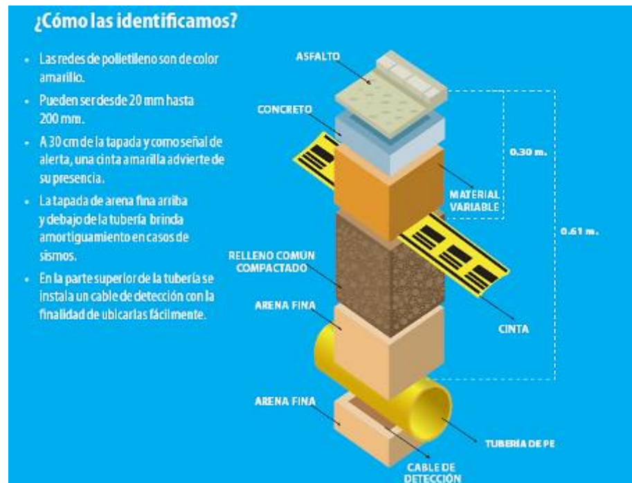
FIGURA 2. 8 INSTALACIÓN DE REDES EXTERNAS DE POLIETILENO
