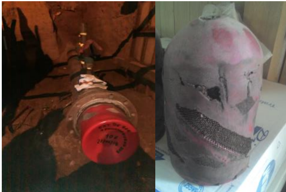
Figura 3. 88 RASCADORES PARA LIMPIEZA O BRUSHING PIG.
