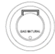
DETALLE 2 REGISTRO DE POLIVALVULA PARA EXTENSOR (Ø 150mm x Ø 200mm)
