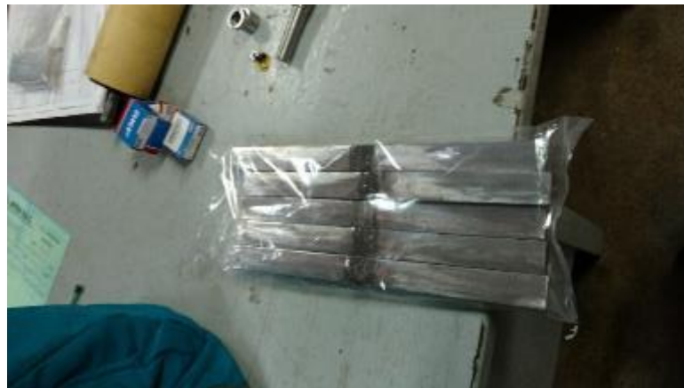
FIGURA 3. 20 ESPECÍMENES MAQUINADOS PARA TRACCION
