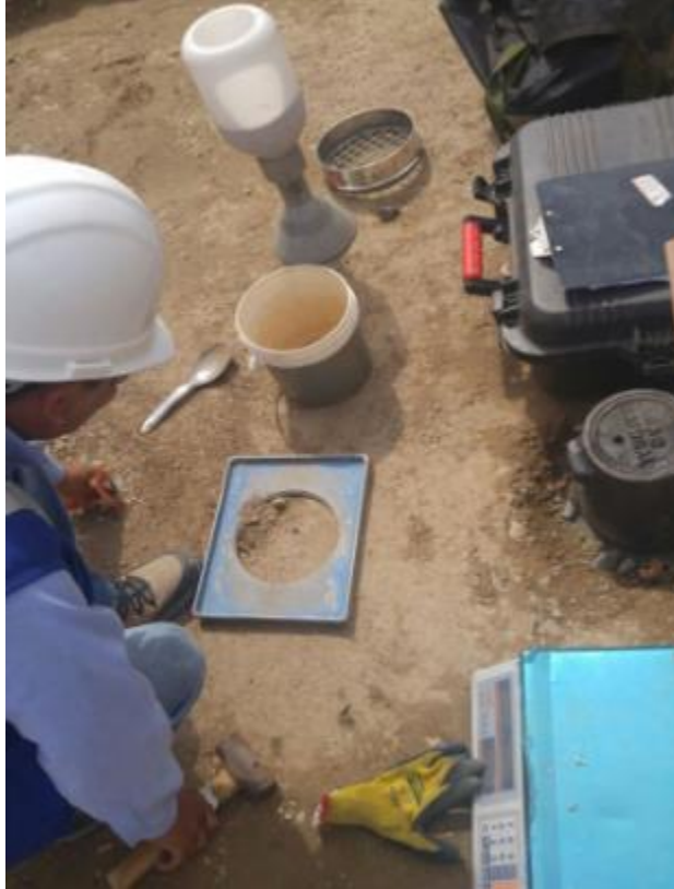
Figura 3. 98 VERIFICACIÓN POR MÉTODO DENSIDAD DE CAMPO.
