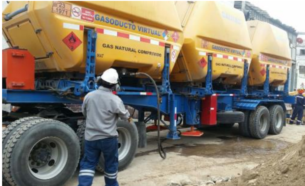
Figura 3. 127 GASODUCTO VIRTUAL, PARA TRANSPORTE DE GAS COMPRESIDO.
