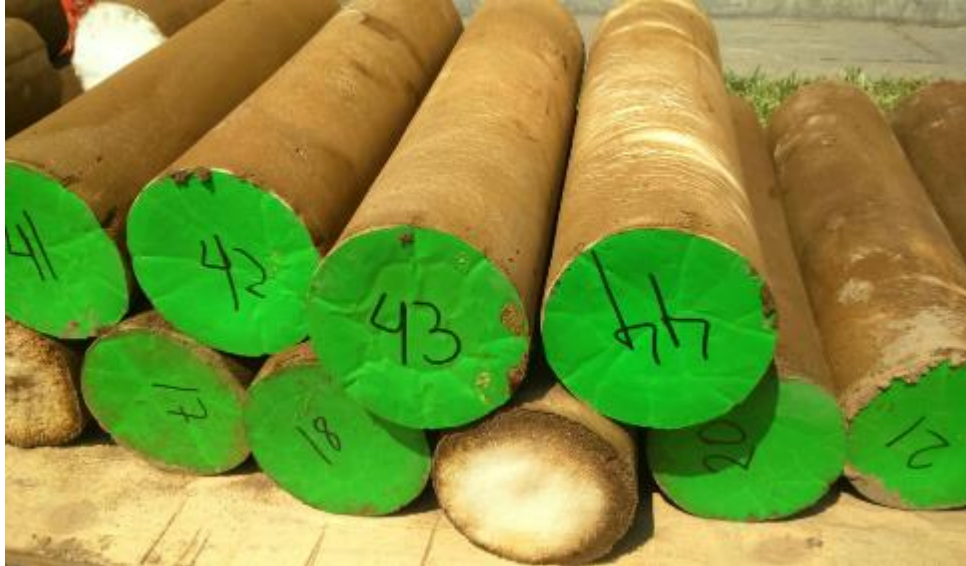
Figura 3. 87 ESPUMAS PARA LIMPIEZA O FOAM PIG.
