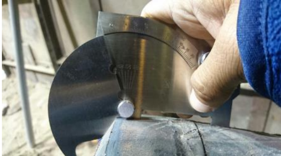
Figura 3. 57 VERIFICACIÓN DE BISELADO
