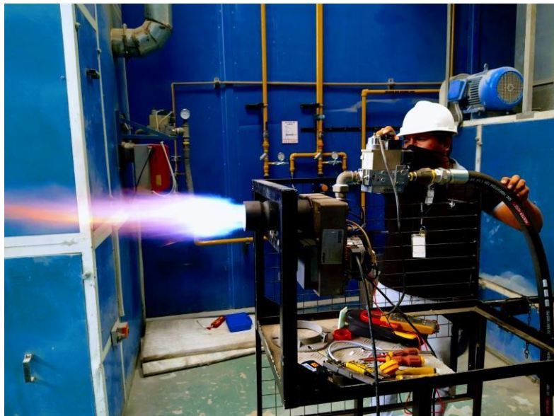
Figura 3.39: Puesta en marcha y graduación de los quemadores.
