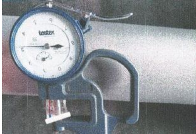
Figura 3.28: Medición de la rugosidad de tuberías.
