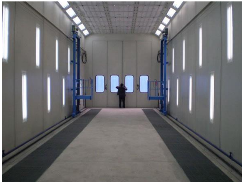
Figura 2.21: Interior de la cabina de pintura Modabus.
