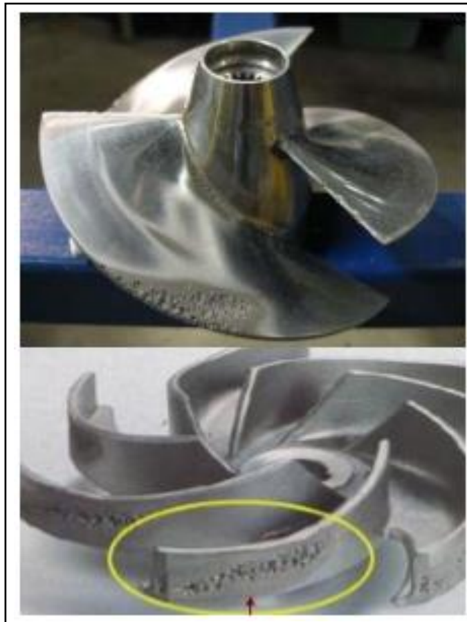
Fig. 29 Erosión de Cuerpos Metálicos
