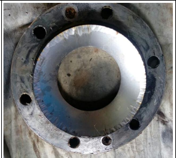
Fig. 76 Asiento de Tobera de Inyector
