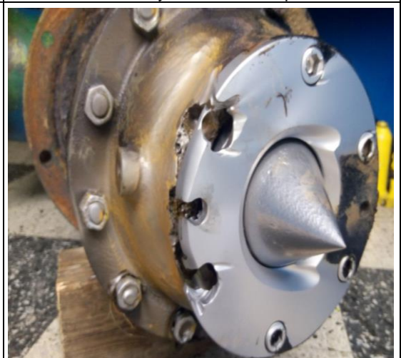
Fig. 74 Tobera y aguja de Inyector
