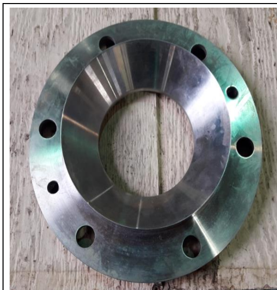
Fig. 125 Asiento de Tobera de Inyector
