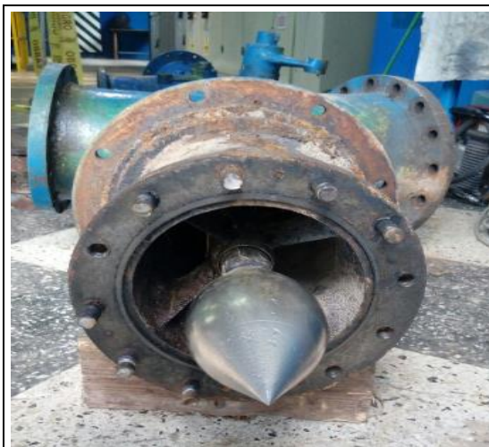
Fig. 77 Aguja de Inyector
