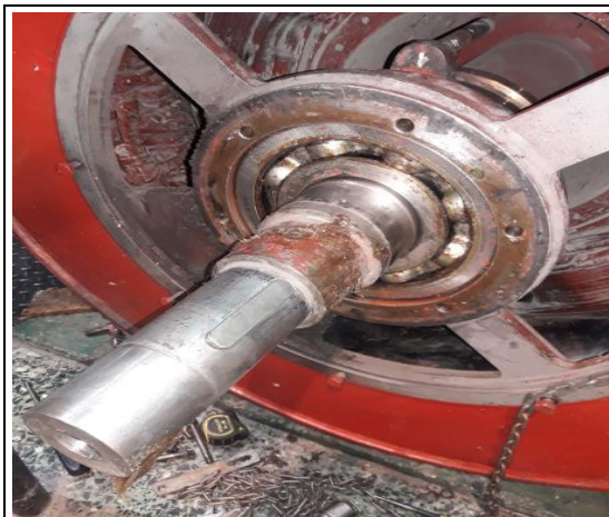
Fig. 59 Rodamiento de Rotor del Generador
