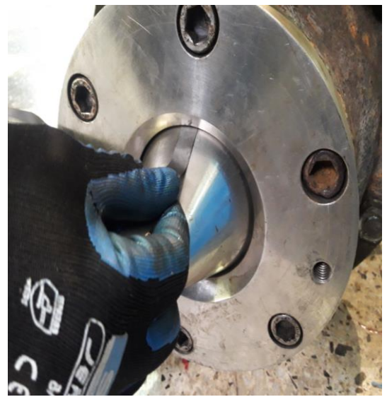
Fig. 128 Medición de luz entre aguja y tobera del Inyector
