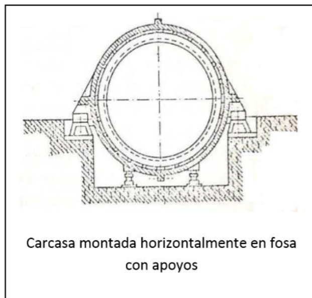
Fig. 33 Estator del Generador
