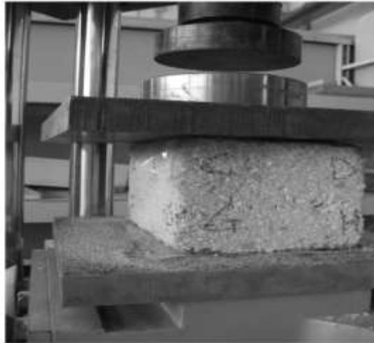
*Nota.* Las muestras de prueba generalmente comprenden entre cinco y diez bloques. La carga de compresión se impone siguiendo un procedimiento controlado por carga (Enrico Quagliarini & Lenci, 2010) o controlado por desplazamiento (Lenci, Piattoni, Clementi, & Sadowski, 2011).
