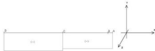
Diagrama 3. Diagrama de momento flector en Y. Fuente propia.
