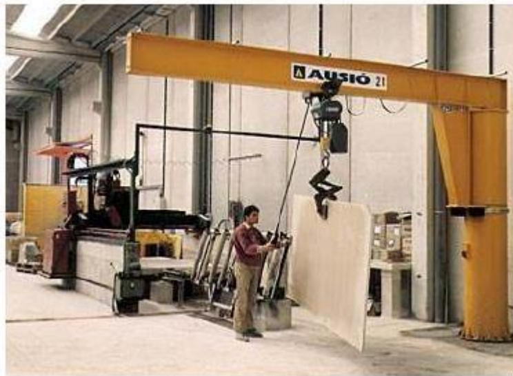
Grúa giratoria de columna fija con sistema de 2 rodamientos
