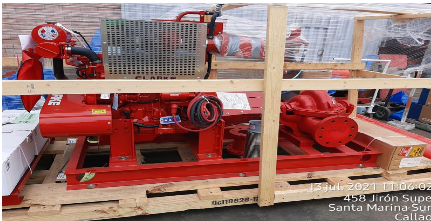
Figura 17 Bomba Contra Incendios (Skip)
