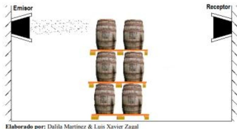
No se recomienda el uso de detectores de gases, ya que tanto en la bodega uno y dos se almacena alcohol etílico y esta sustancia genera un tipo de gas que para el sistema podría generar una señal errónea de alarma.
