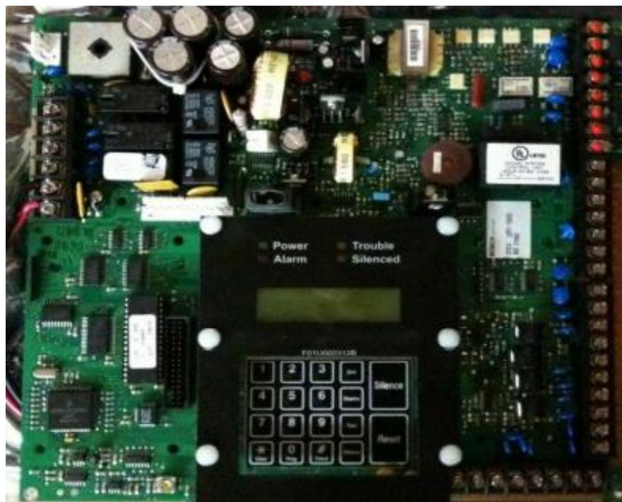
**Figura N°32 Diagrama placa de control D7024**
