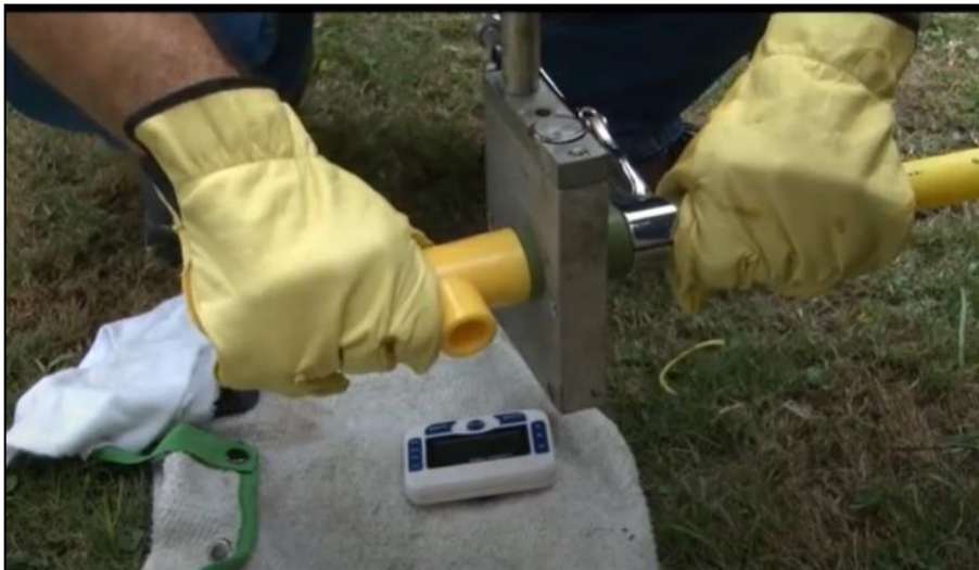
Figura II.18 Fusión con plancha calefactora
