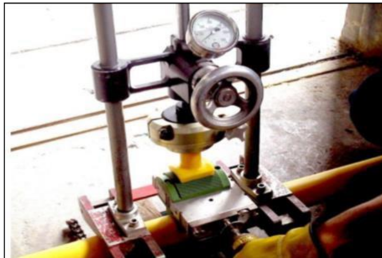
Figura II.19 Fusión de silleta con tubo de 63mm
