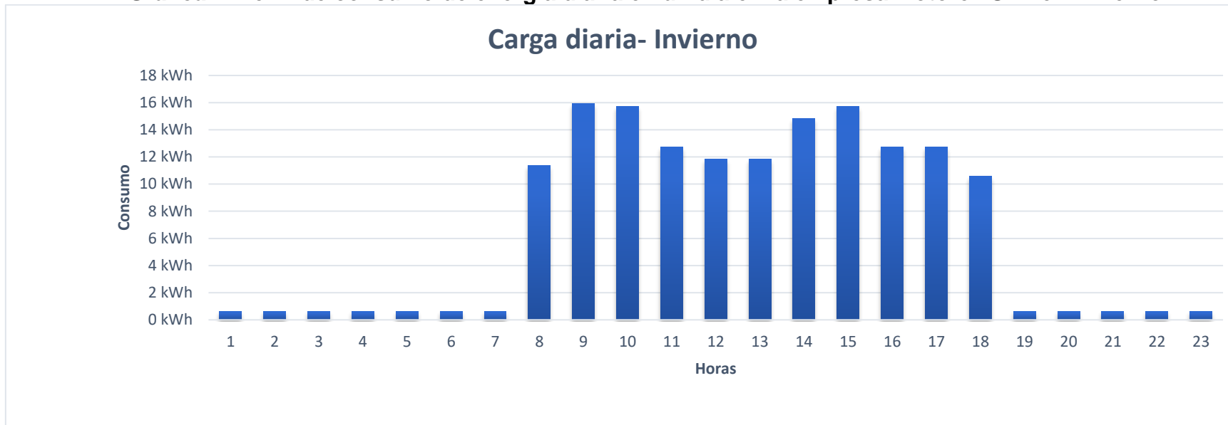
Gráfica 2. Perfil de consumo de energía diaria en un día en la empresa Motorex S.A. en invierno
