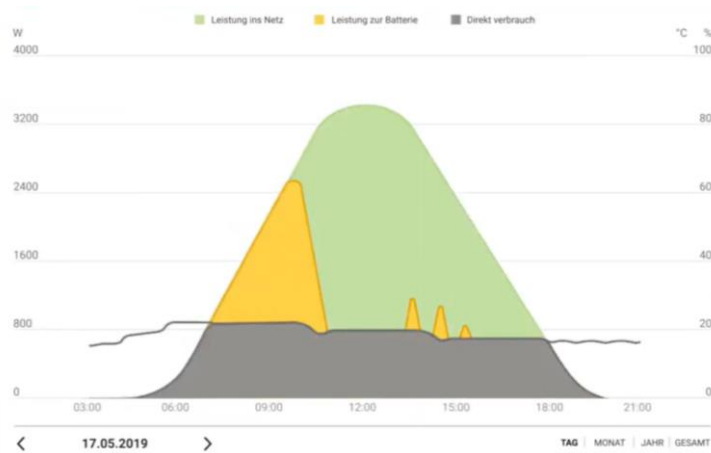
Figura 18 Diagrama de cantidad de energía generada durante el día. Tomado del software de inversor marca Fronius.
