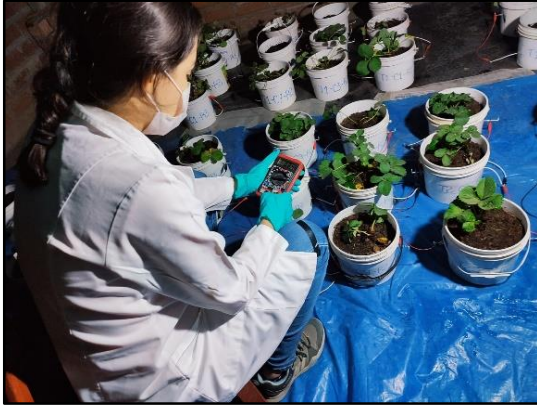
25. Medición de las CCPM en Circuito Abierto a las 20:00 horas.
