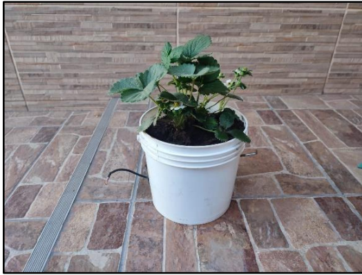
13. Celda de Combustible Planta Microbiana (CCPM) terminada.
