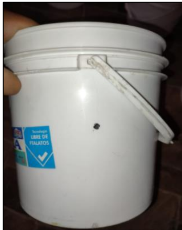
5. Perforación lateral de la celda para la colocación del cátodo.
