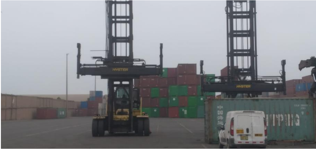
Figura 1. Equipo Big Truck RS45
