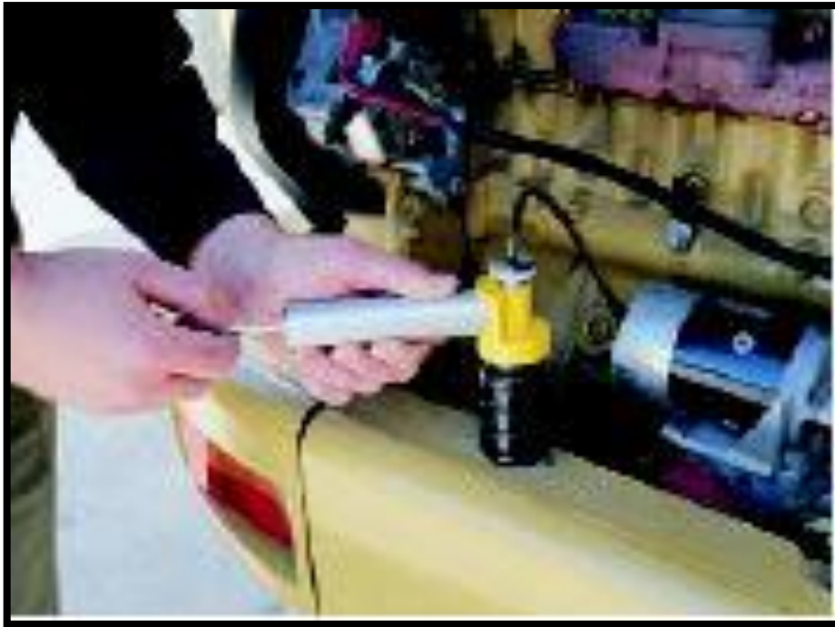
Figura 25 TOMA CORRECTA DE MUESTRA ACEITE
