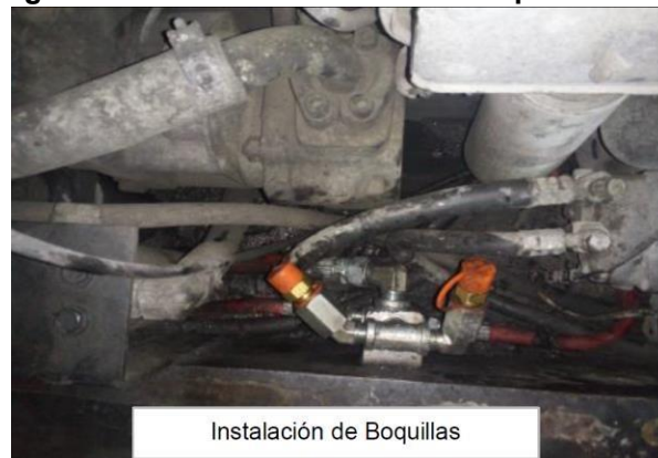
Figura 3.18: Instalación de boquillas o toberas
