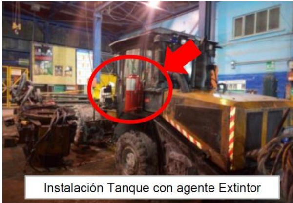
Figura 3.16: Instalación de tanque y monitor de control
